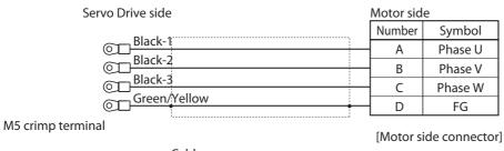
Cable 10 mm $^2 \times$  4C or AWG11  $\times$  4C
